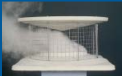
visualisation de l'évacuation du flux avec une fumée artificielle
