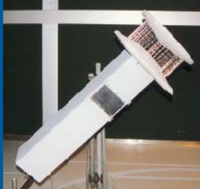
l'extracteur statique Sebico en veine sur platine d'essais (variation de l'azimut et de l'inclinaison par rapport au vent).
