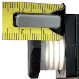
exemple de réglage de cote 15 mm
