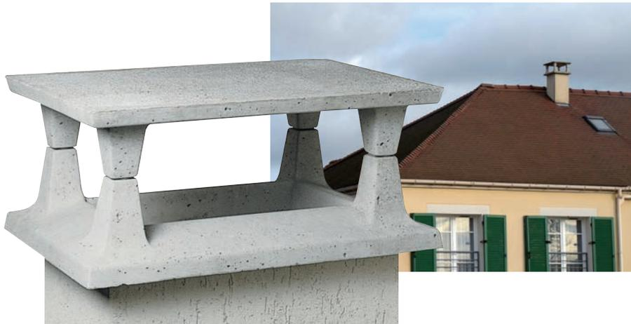
La forme de la dalle en pointe de diamant et la hauteur entre la base et la dalle accélèrent la sortie des fumées, suppriment le phénomène de bouchon, et permettent le passage du hériss pour le ramonage
