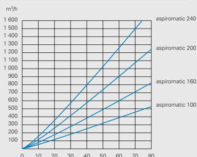
Aspiromatic est un appareil anti-refouleur puissant et un régulateur de tirage parfait. L'expérience a, depuis plus de 30 ans, confirmé ces qualités. Ses performances établies par les essais effectués au Laboratoire Eiffel sont résumées dans la courbe ci-dessous.
