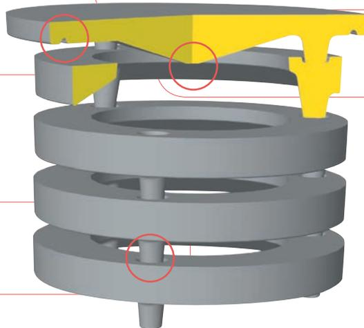
La forme de la dalle en pointe de diamant accélère la sortie des fumées et supprime le phénomène de bouchon.
