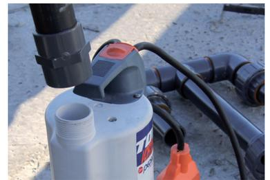
Visser la rallonge tube Ø40 mm sur la pompe et mettre un collier de serrage sur le câble à 3 cm au dessus du raccord de la pompe.
