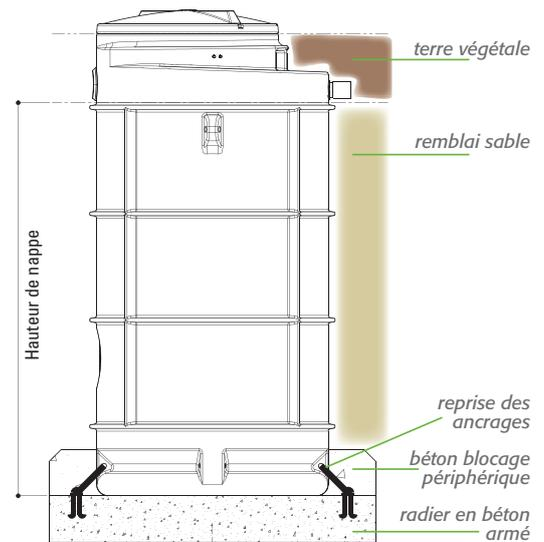
*Dans les cas où une dalle de répartition, un mur de soutènement ou une semelle en béton est nécessaire, une étude précise, qui prend en compte les facteurs externes tels que le poids de la charge, la fréquence de la charge roulante, les poussées latérales, la hauteur de la nappe phréatique... doit être menée.*
