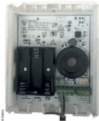
Le boîtier d'alarme de niveau BAN220 de Sebico est alimenté par une prise 220 V et trois piles AA 1,5 V non rechargeables afin de continuer à fonctionner en cas de coupure d'électricité.
