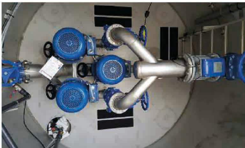
La gamme Sidinox de diamètre 1.50 à 3.00m peut être équipée de système de pompage en ligne directe à 1, 2 ou 3 pompes allant de 1.5kW à 132 kW.
