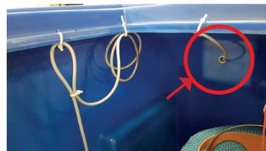
Si la longueur de câble fourni ne permet pas d'aller au boîtier (IP65), il faudra utiliser le connecteur fourni. Il sera installé dans le séparateur et maintenu contre la cuve au moyen de colliers plastiques pour éviter qu'il ne gêne la sortie du bloc coalescence lors de son entretien.
