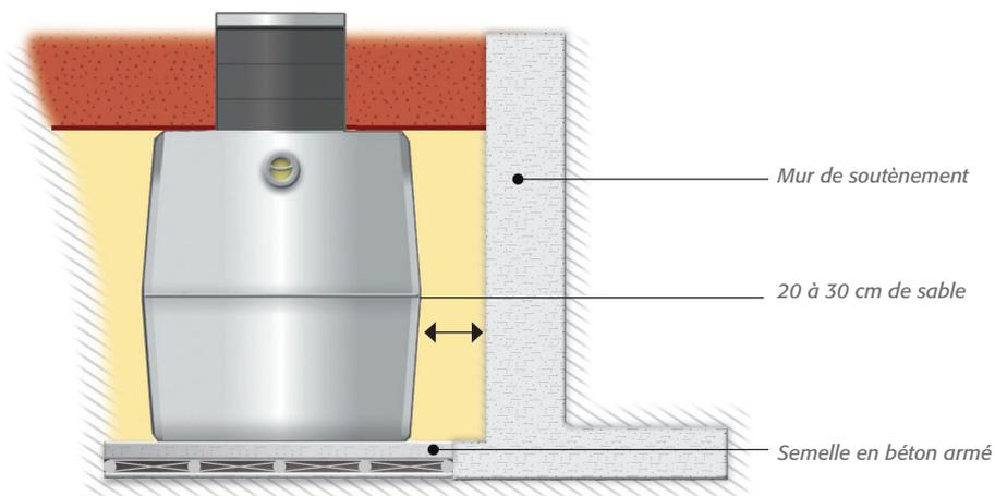
*Dans les cas où une dalle de répartition, un mur de soutènement ou une semelle en béton est nécessaire, une étude précise, qui prend en compte les facteurs externes tels que le poids de la charge, la fréquence de la charge roulante, la poussée latérale, la hauteur de la nappe phréatique... doit être menée. Nous vous conseillons de faire appel à un bureau d'étude spécialisé.*
