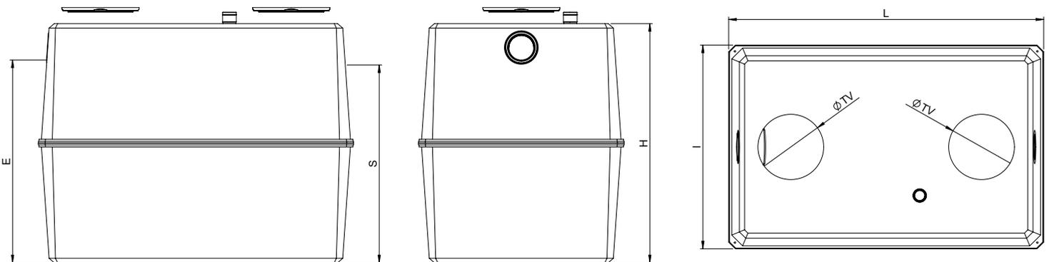
Installation hors passage de véhicules et absence de nappe phréatique. Remblai supérieur de 50 cm maximum.
