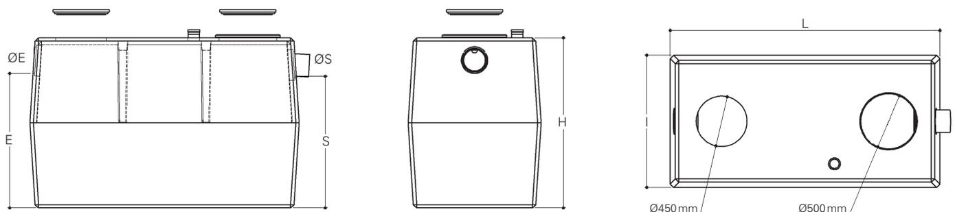
L'installation des appareils doit respecter les règles de l'art et les consignes de notre notice de pose fournie avec chaque appareil également disponible sur demande ou sur notre site internet [www.sebico.com](http://www.sebico.com). Séparateurs de catégorie 1D : installation hors passage de véhicules et absence de nappe phréatique. Remblai sur la cuve de 50 cm maximum.
