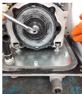
6- Enlever l'écrou ou la vis de la membrane, et la retirer.
