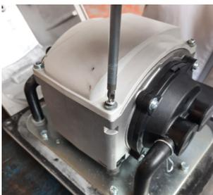
3- Retirer l'amortisseur de chocs en mousse. Retirer les 4 vis du couvercle sauf sur modèle EL-S 120.
