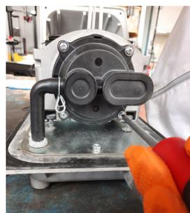
5- Retirer les 4 vis de la boîte à clapet. Faire glisser le collier de serrage du tube vers le bas. Enlever le tube de la boîte à clapet.
