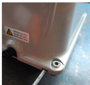
2- Retirer le capot. S'aider en insérant un tournevis plat dans l'encoche situé à l'arrière du surpresseur.
