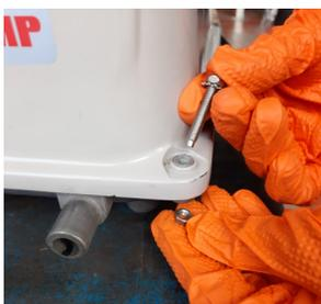
1- Retirer les 4 vis de fixation situées aux coins du capot.
