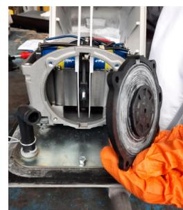
7- Mettre la nouvelle membrane et la fixer avec l'écrou ou la vis.
