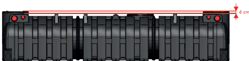
Exemple 1 : cuve 15000 avec filtration intégrée et sans kit réhausse
