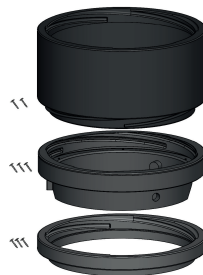
Kit KTRHH composé d'une réhausse RHS65P, d'une collerette C9T059, d'une réhausse grande taille RHV66P ses 6 vis de fixation
